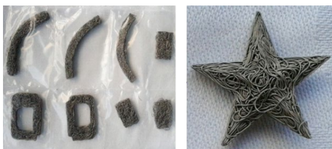
図1. 様々な形状の純Mgワイヤ多孔質体 (ジャパンファインスチール(株)提供)
