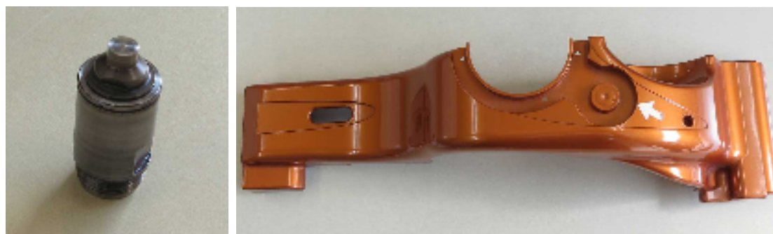
図表7. 15 プラスチック射出成形ノズル(左)と それを使用して製造したパチンコ台の部品(右)
