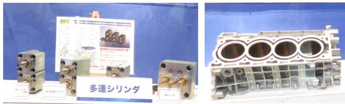
図表 7. 13 金型用中子抜き油圧シリンダ(左)とそれを使用して作られた製品(右)
