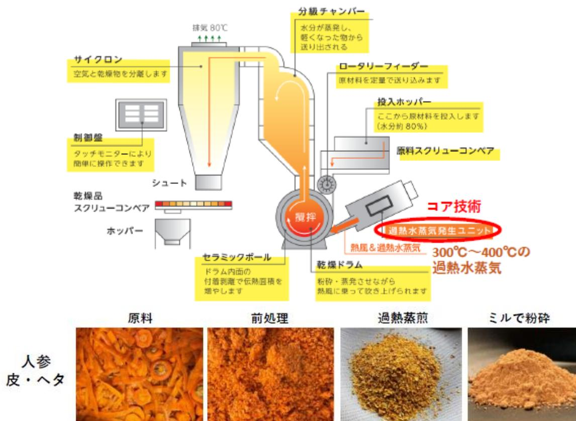
(事前に原料をある程度細かくし、機械に投入。過熱蒸煎機を通して出てきたものをさらにミルで粉末化)
