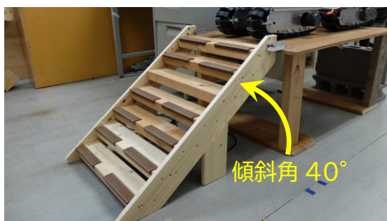
図 2 : 傾斜角 40^\circ 縮尺比 1/2.83 の階段
