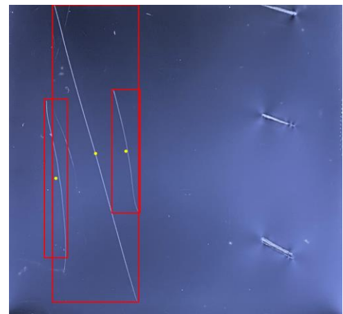
図3 削る傷検出プログラムの実行結果
