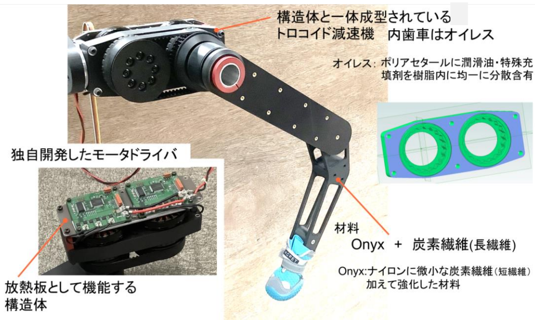
図 5 開発した 4 足歩行ロボットの脚
