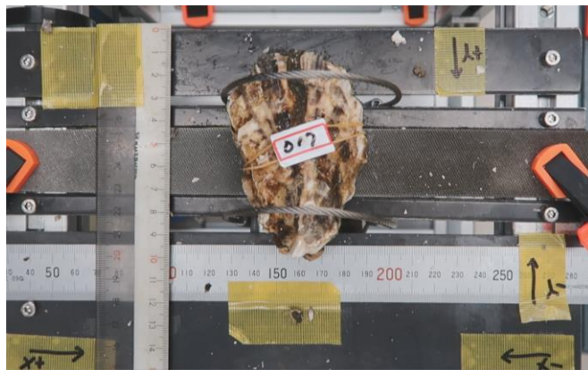
図5 把持・固定機能検証の実験記録状況
