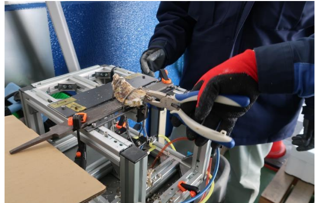
図8-b 改良後の試作機(ワイヤー間距離 50 mm)
