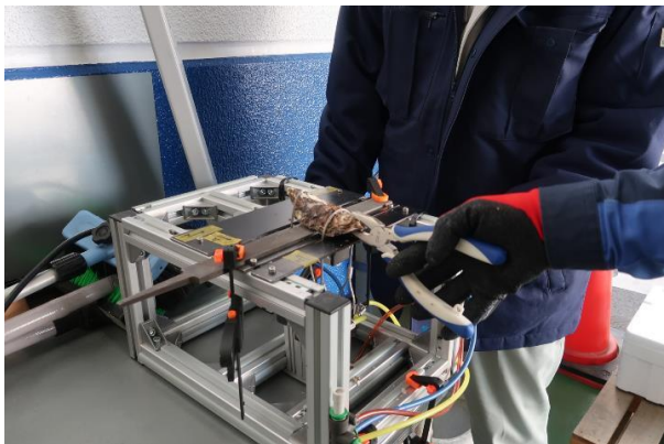
図8-a 改良前の試作機(ワイヤー間距離 60 mm)
